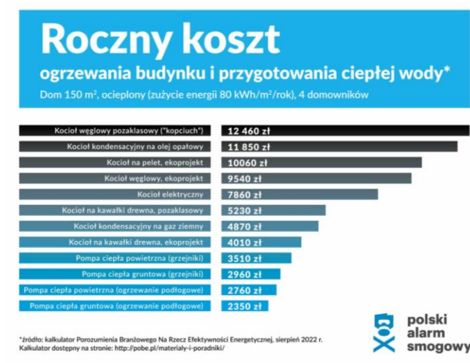
Rysunek 45. Porównanie kosztów ogrzewania budynku mieszkalnego
